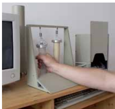
Zestaw do diagnostyki i rehabilitacji ręki pomiar siły ścisku
